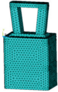
图4 沪通长江大桥沉井基础
