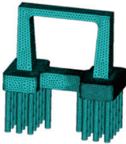
图6 厦漳大桥高桩基础
